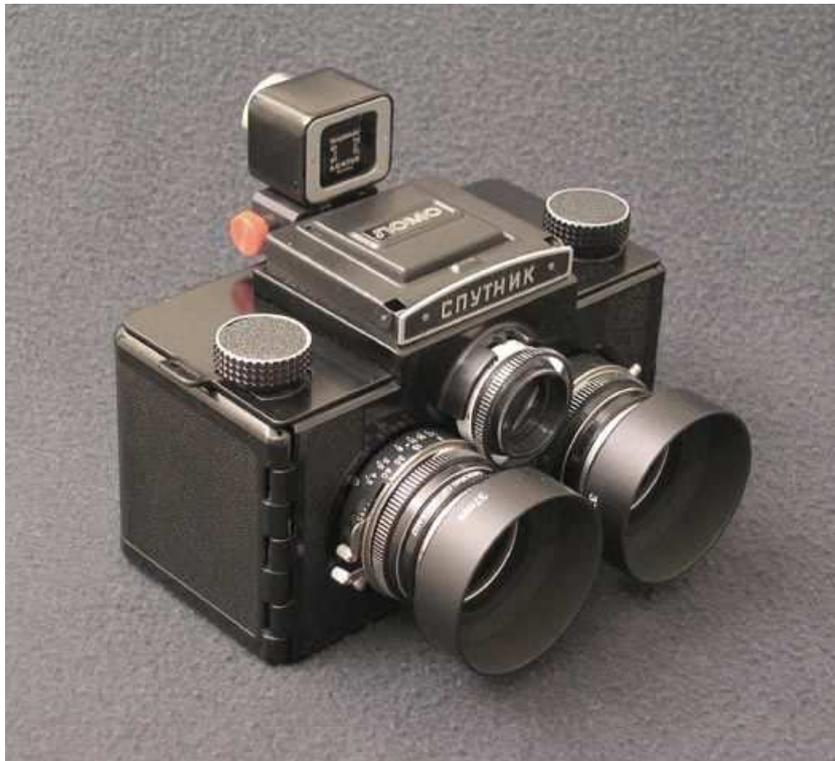
**Рис. 13.** "Спутник" с установленной верхней фальш-панелью, с башмаком под дополнительный видоискатель 6x6 Kontur Voigtlander и ушками для крепления нашего ремня. Шахта (шильдик сменен), ручки перемотки пленки, рычаги взвода и спуска затвора, а также передний блок объективов заменены на таковые от "Любитель-166В". На объективы надеты бленды 37 мм через понижающее кольцо (фото с: <http://users.adelphia.net/~jp1/Sputnik/index.html>). Автор: Jeff Pierce.
