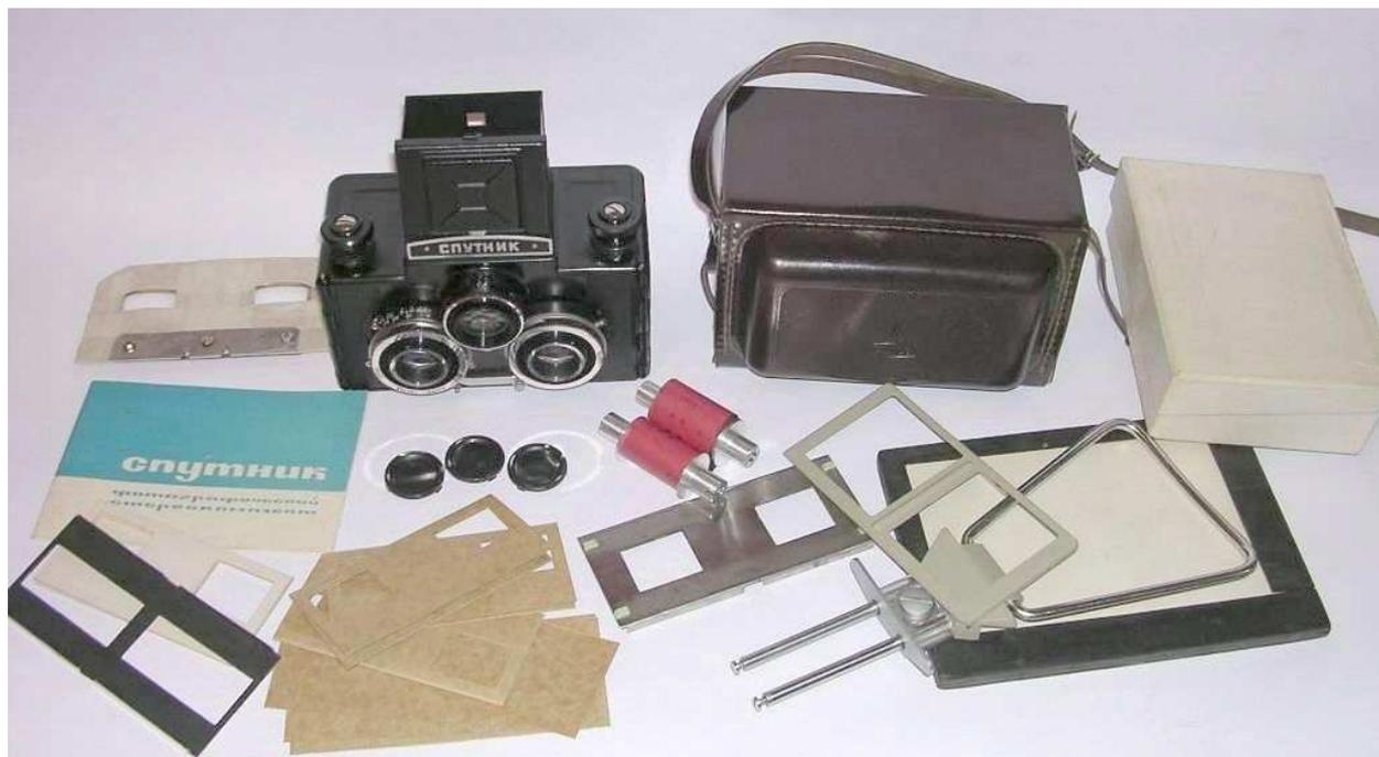
**Рис. 17.** Стереокompлект, выставившийся на торги интернет-аукциона Молоток.ру в 2005 году, из которого только фотоаппарат, описание, чехол и основание стереоскопа являются оригинальными. Рамки для просмотра и съёмки (вставляются внутрь камеры) под разный формат кадра, а также катушки под 35-мм плёнку являются самодельными (фото с: <http://molotok.ru/>).
