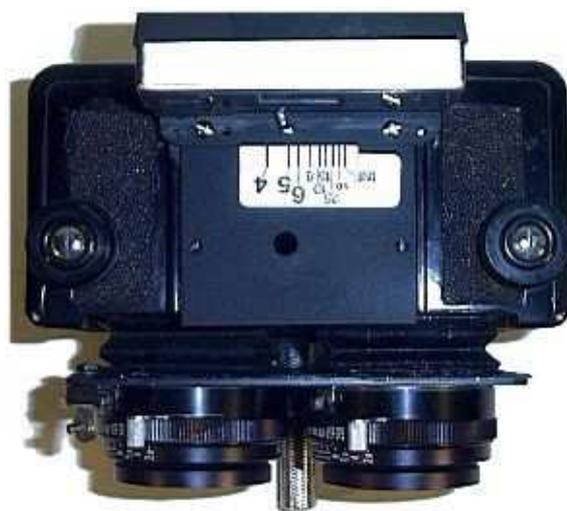
**Рис. 11.** Практически полностью переделанный фотоаппарат "Спутник", от которого остались только корпус, задние крышки, ручки перемотки, а также рычаг переключения диафрагм. В новой камере использована оптика Mamiya С330 (фото с: <http://seriousviewers.com/projects/mfcam2/mfcam.htm>). Автор: Alan Lewis.
