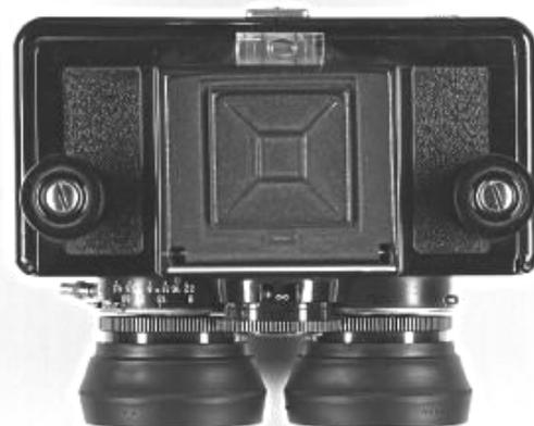
**Рис. 14.** "Спутник" с установленными передними оправами объективов от "Любитель-166В" (слева), присоединенными к ним блендами и уровнем за шахтой (справа) (фото с: <http://www.pauck.de/marco/photo/stereo/sputnik/spruijt/spruijt.html>). Автор: Michel Spruijt.
