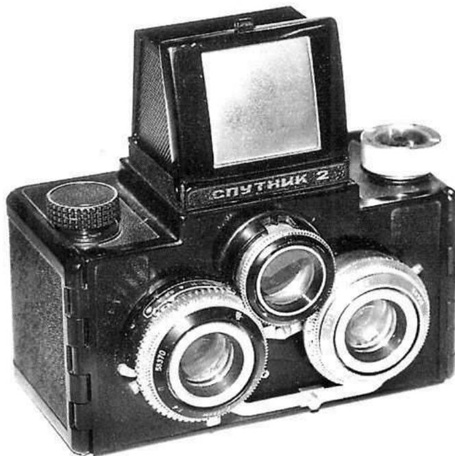
Рис. 9. Стереофотокамера "Спутник-2" (фото с: <http://www.photohistory.ru/StereoCam.htm>).
