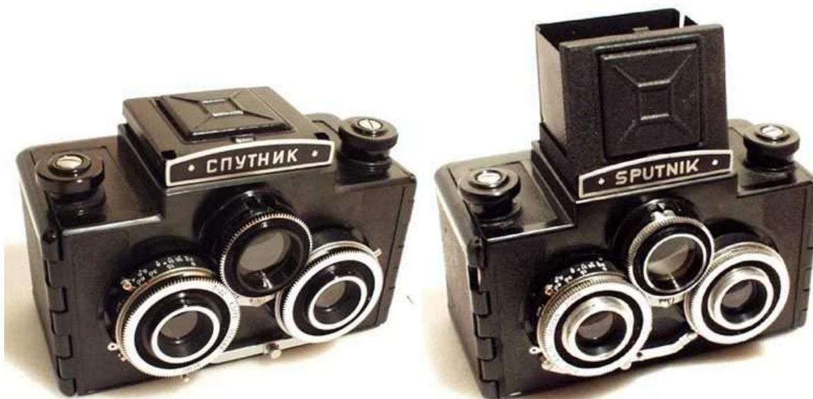
Рис. 6. Отечественный и экспортный варианты оформления стереофотоаппарата "Спутник" (фото с: <http://www.fotoua2.com/Sputnik.html>).
